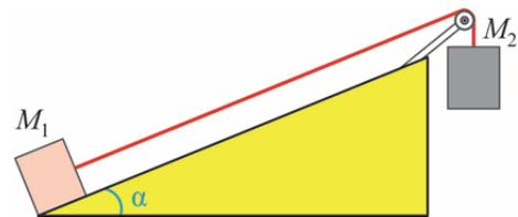
A figura precedente ilustra um plano inclinado em que o bloco de massa  $M_1$  está ligado ao bloco de massa  $M_2$  por meio de um fio ideal que passa por uma polia também ideal. O bloco de massa  $M_1$  pode se movimentar, sem atrito, sobre a rampa, que tem inclinação  $\alpha$  relativamente à direção horizontal.
