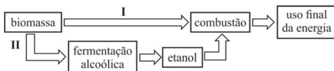
Os processos I e II, indicados na figura acima, são necessários quando a biomassa é utilizada na geração de energia. Nos dois processos, a etapa de combustão resulta em pelo menos dois produtos: gás carbônico ( $\text{CO}_2$ ) e vapor de água ( $\text{H}_2\text{O}$ ).
