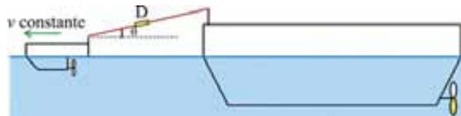
O diagrama acima representa um rebocador e um navio conectados por dois cabos de aço unidos pelo dinamômetro D. O rebocador desloca-se com velocidade constante  $v$ , a mola do dinamômetro está distendida 50 cm da sua posição de equilíbrio e o ângulo que os cabos fazem com a horizontal é  $\theta = 30^\circ$ .
