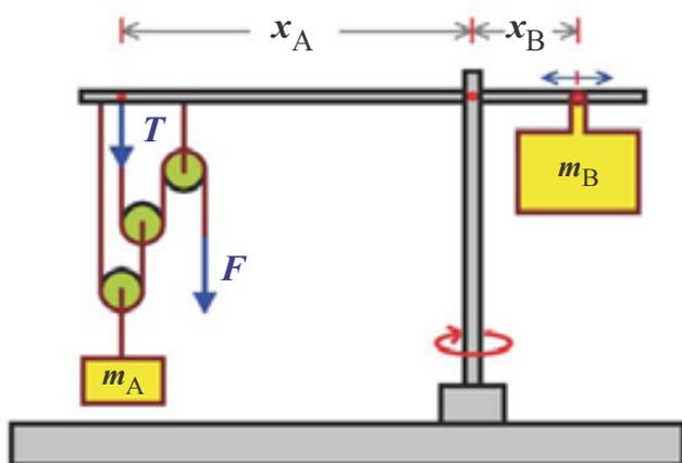
A figura acima ilustra um sistema usado para levantar e mover cargas em um navio. Esse sistema é formado por um conjunto de polias ideais montadas no braço esquerdo de uma grua; no braço direito, há um contrapeso móvel, de massa  $m_B$ , localizado à distância  $x_B$  do eixo de suporte da grua. Um contêiner de massa  $m_A$  que está à distância  $x_A$  do eixo de suporte da grua é levantado pela força  $F$  por meio das polias.
